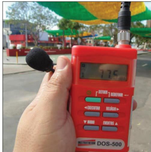
Figura 6 - Dosímetro Digital, Fabricante- Instrutherm, Identificação: 120902197, Modelo: DOS-500, Nr. Série: 120902197.
