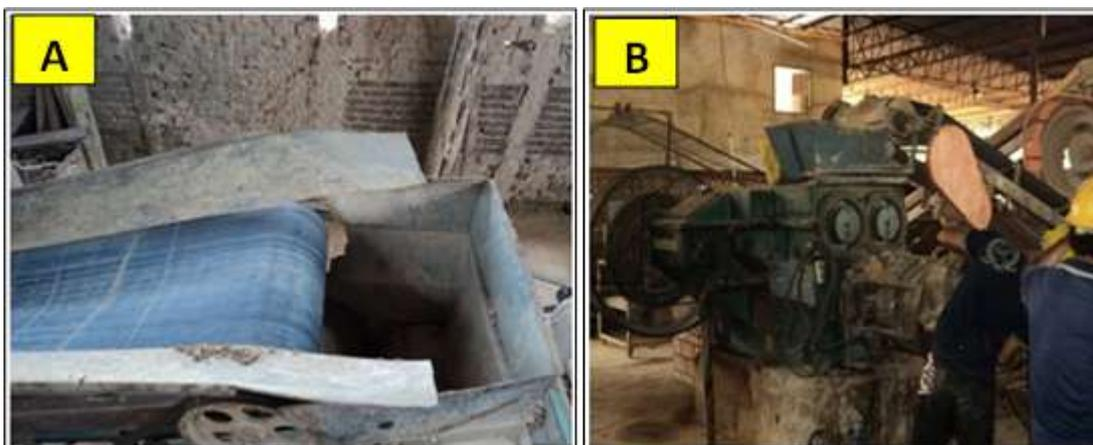
Figura 4.16 – Equipamentos do processo: (A) Esteira e (B) Maromba. (Empresa em estudo, 2015).
